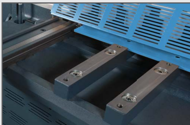
Шариковые опоры, зафиксированные на стальных блоках стола для удобной подачи листов.
