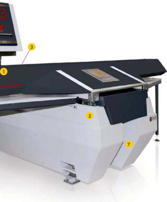
Благодаря входящим в стандартную комплектацию большим щеточным столам можно расположить самые разные заготовки на листах стандартных размеров. Скоростные оси с сервоприводами переменного тока, X и Y, с ходом 2032 и 1524 мм соответственно для Q3 или 2540 и 1524 мм для Q4, а также 3 гидравлических зажима для листа с минимальной «мертвой зоной» 225 на 95 мм обеспечивают высочайшую точность на всех заготовках (по дополнительному заказу возможно позиционирование от ЧПУ).
