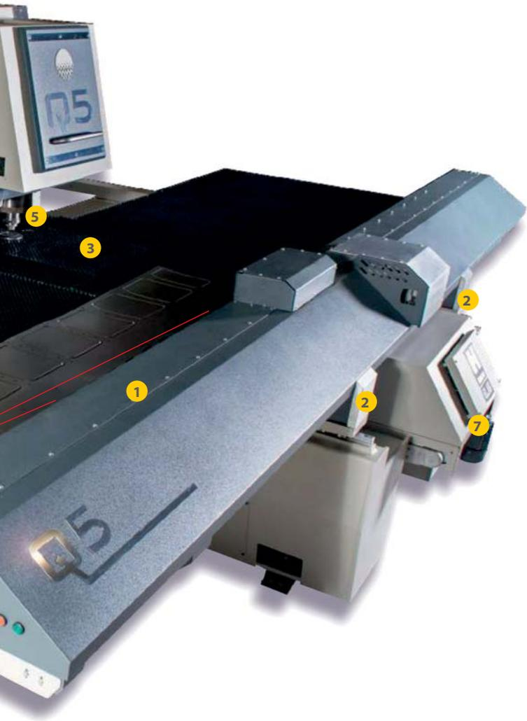
Благодаря входящим в стандартную комплектацию большим щеточным столам можно расположить самые разные заготовки на листах стандартных размеров. Скоростные оси с сервоприводами переменного тока, X и двойная Y, с ходом 2540 и 1580 мм соответственно либо 3000 и 1580 мм, а также 3 гидравлических зажима для листа с минимальной «мертвой зоной» 225 на 95 мм обеспечивают высочайшую точность на всех заготовках.
