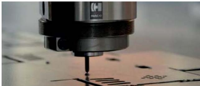
Традиционная нарезка резьбы плавающим метчиком или жесткая нарезка с интерполяцией, по выбору. На координатно-пробивные прессы с одной головкой серии Q можно установить традиционную систему нарезки резьбы плавающим метчиком, используя специальный держатель метчика. Данный специальный держатель плавающего метчика производит перемещение метчика вверх-вниз, в то время, как ось C1 производит вращательное движение метчика.
