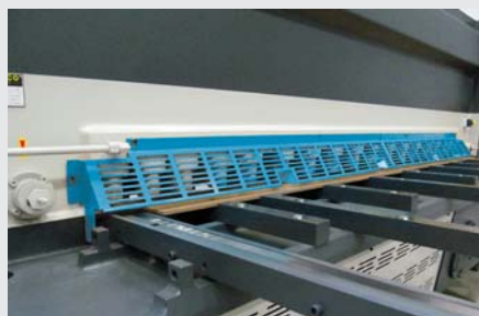
ВЫРАВНИВАЮЩИЕ СУППОРТА ДЛЯ ПЕРЕДНЕЙ ПОДДЕРЖКИ со шкалой или без шкалы, Т-образными пазами и упором. Длина варьируется от 1000 до 6000 мм и от 500 до 3000 мм, соответственно
