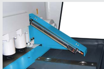
ЗАЩИТНЫЕ СВЕТОВЫЕ ЗАВЕСЫ в передней части прижимов. Шариковые опоры, зафиксированные на стальных блоках стола для простой подачи листов
